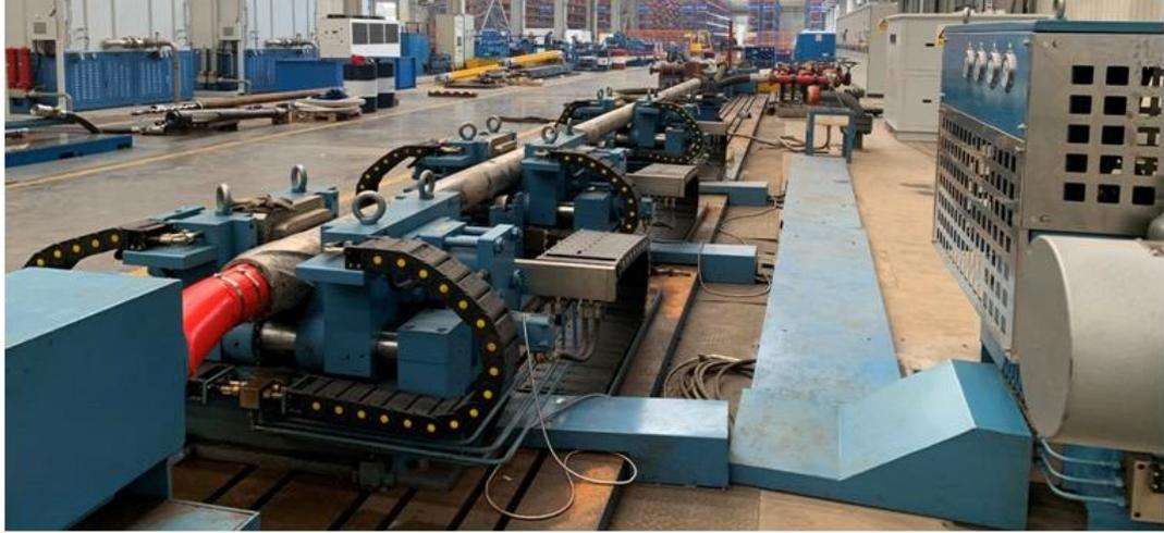
图 14 随钻仪器及导向工具全排量测试实验系统主要组成装置
