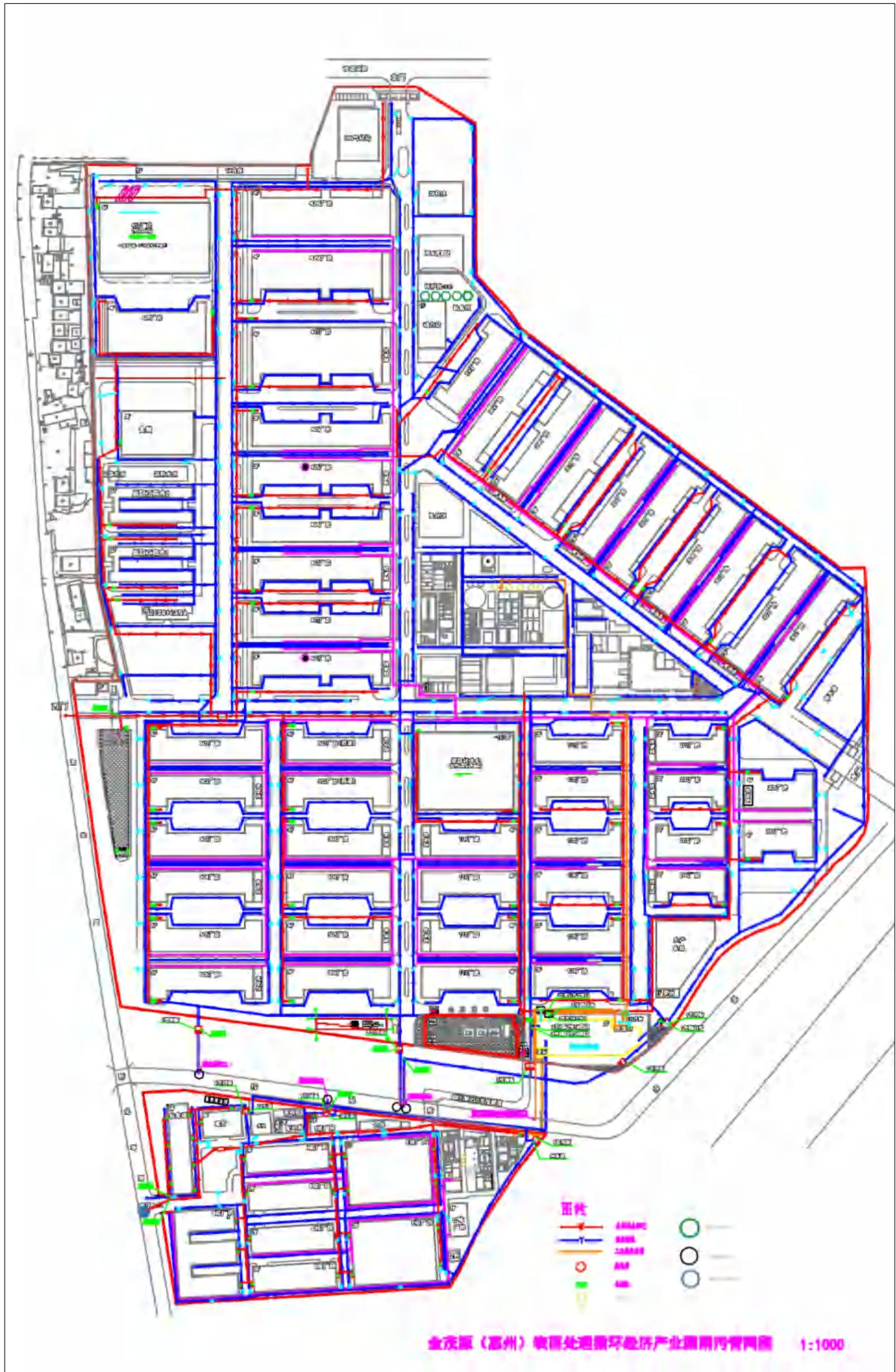
图 2.7-1 企业雨污管网图
