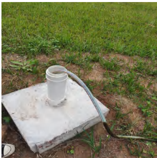
地下水点位D02洗井
