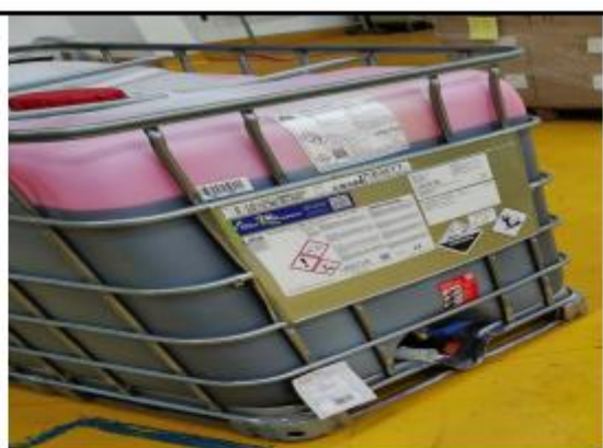
记录二：场景一 - 叉车不慎将装有危险化学品固化剂的IBC桶跌落在地上，但未泄露
