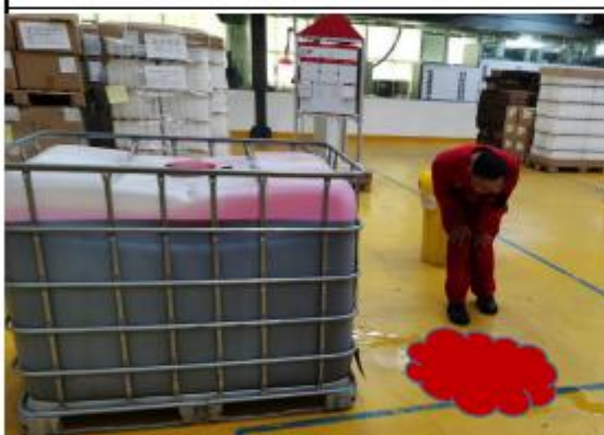
记录三：场景二 - 危险化学品固化剂泄露在了地面上
