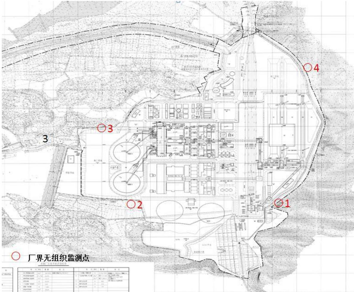
氨储罐区氨气排放监测点位图
