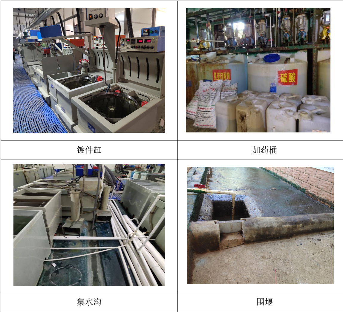
图 4.1.3-16 现场勘察实景
