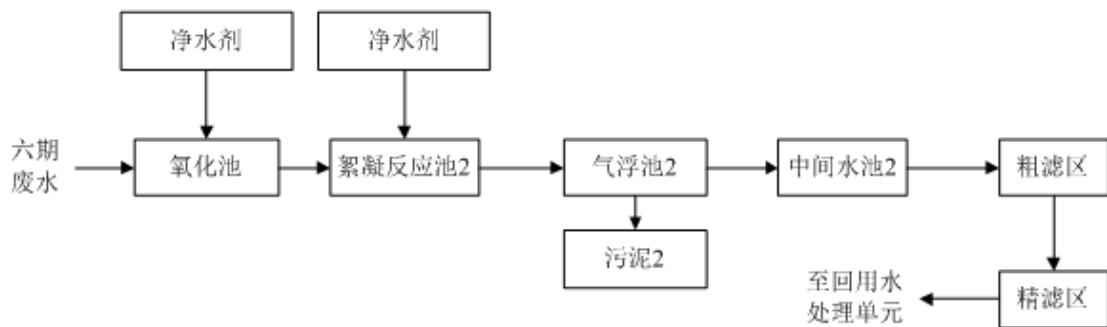
图 2.2-2 泉汇路工厂六期废水（含重金属）处理工艺流程
