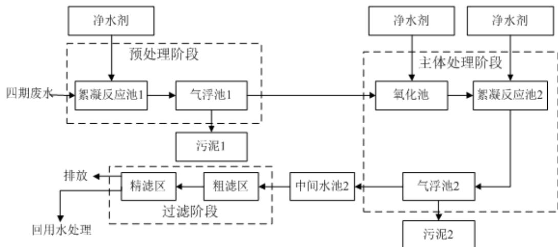
图 2.2-1 泉汇路工厂四期废水（不含重金属）处理工艺流程
