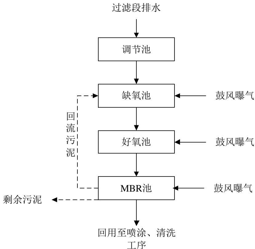
图 2.2-3 泉汇路工厂回用水处理系统工艺流程
