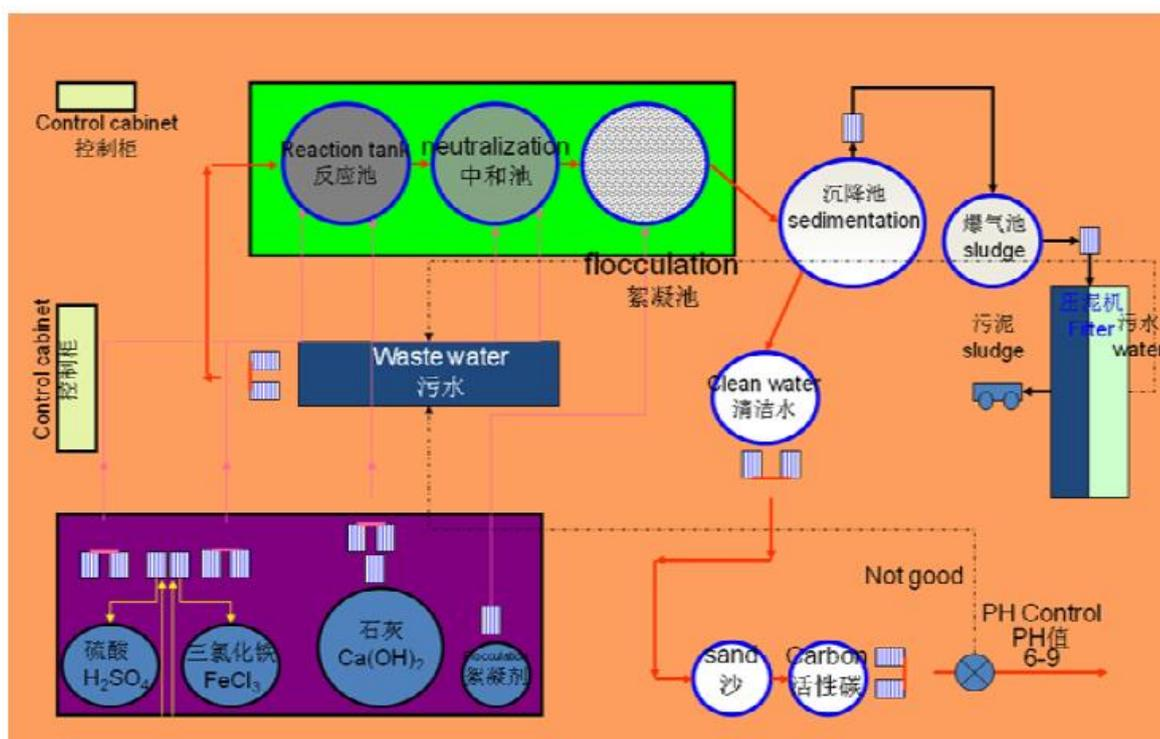
图 2.2-1 福源道工厂污水站工艺流程
