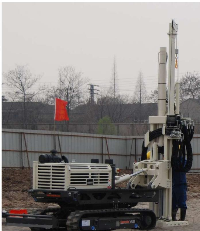
图 6.4-1 土壤取样机械 (Geoprobe)
